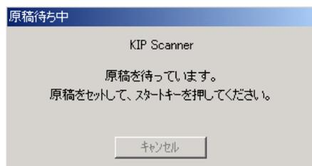
この状態でスキャンを開始せずに「ストップ／排出」ボタンを押して原稿を取り除くと、ScanClient上の操作では待機状態を解除できません。
