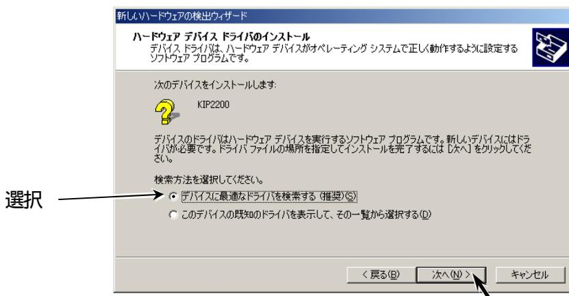
6. 「ドライバ ファイルの特定」と表示されたら、CD-ROM ドライブに KIP2200 インストールディスクをセットします。
