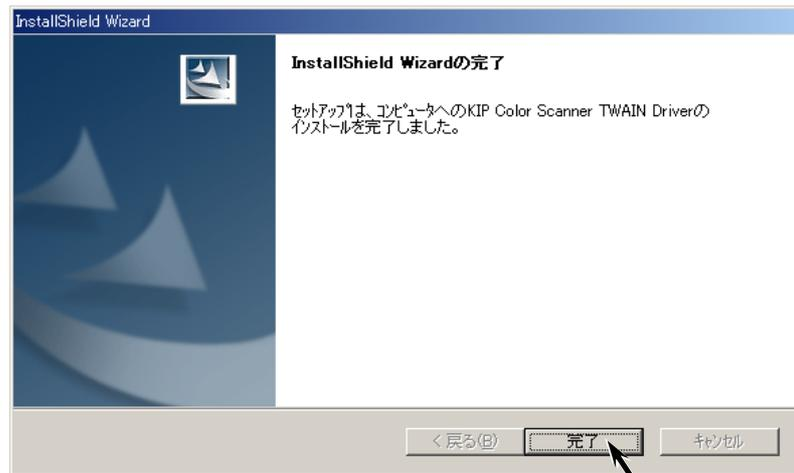
6. USB ドライバ、TWAIN ドライバのインストールが完了すると、TWAIN 対応アプリケーションで KIP2200 カラー scanner を操作してスキャンイメージを取得できるようになります。
