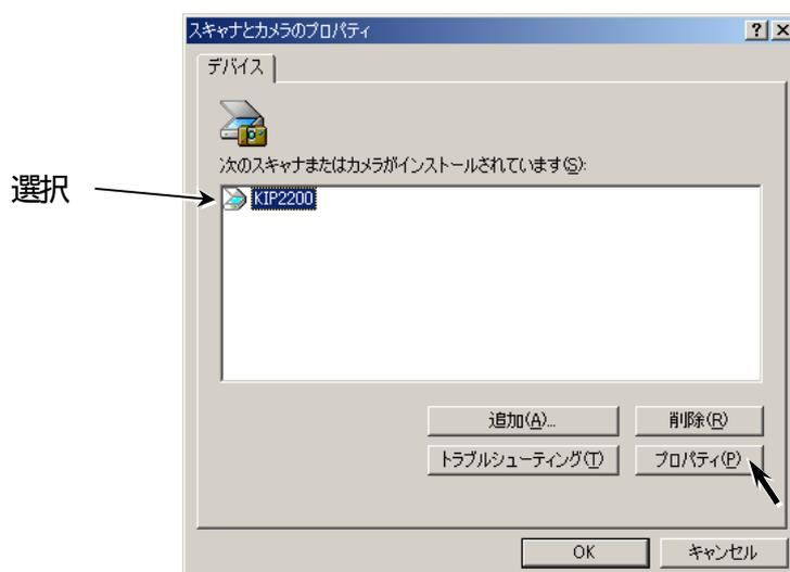
4. 「KIP2200のプロパティ」画面で [状態：準備完了] と表示されていれば、USB ドライバは正常にインストールされています。
