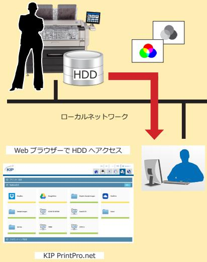
WindowsアプリケーションのKIP ImageProを使用してHDDへアクセス。スキャンイメージの取り込みおよびプリントができます。
